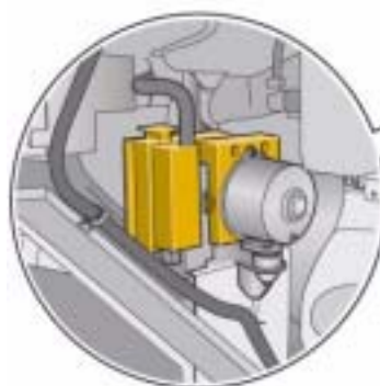
Steuergerät für ABS mit EDS J104 unter der Spritzwand, im Motorraum
