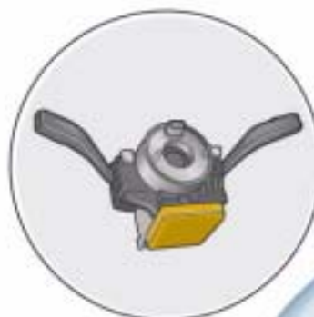
Steuergerät für Lenksäulenelektronik J527 am Lenkstockschalter
