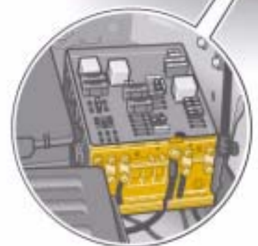
Vorsicherungsbox im Motorraum links
