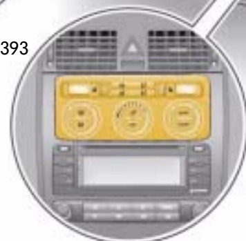
Steuergerät für Climatronic J255 in der Mittelkonsole
