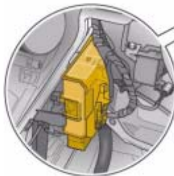
Zentralsteuergerät für Komfortsystem J393 unter der Schalttafel rechts, nähe Mittelkonsole
