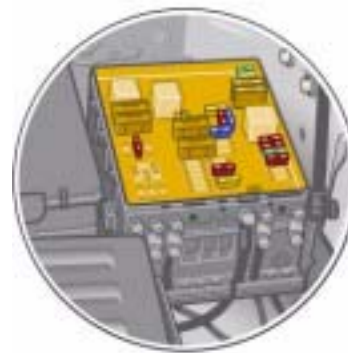
Elektrik-Box im Motorraum links
