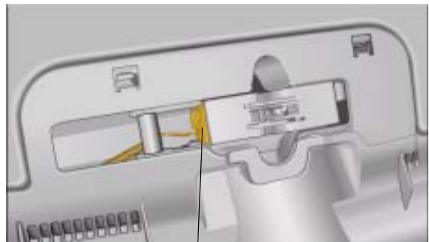
Kontaktschalter für Motorhaube S307_030
