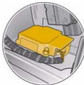
Steuergerät für Airbag J234 unter der Mittelkonsole
