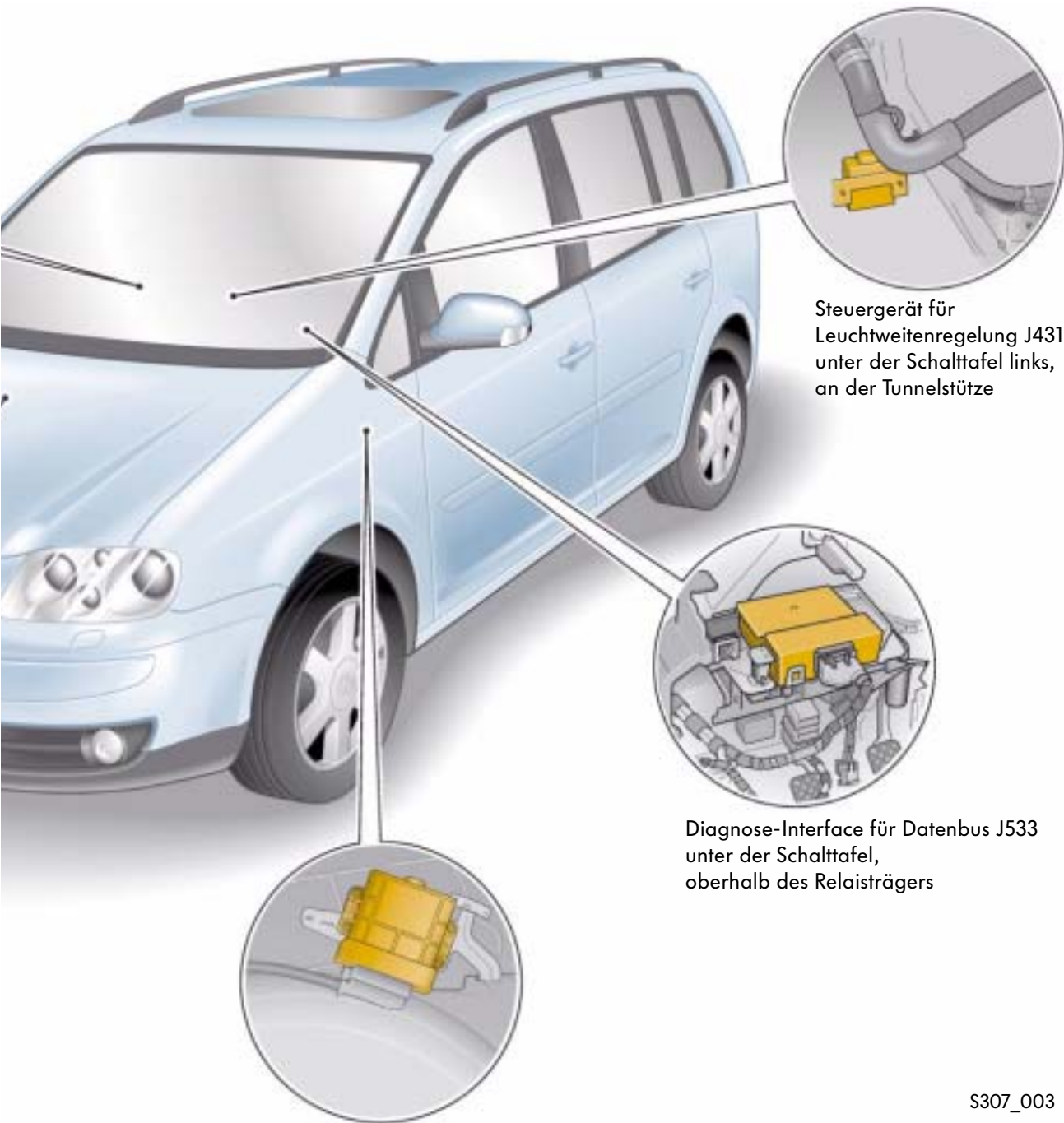
Steuergerät für automatisches Getriebe J217 im Radkasten
