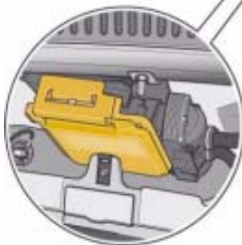
Steuergerät für Motronic J220 unter der Wasserkastenabdeckung
