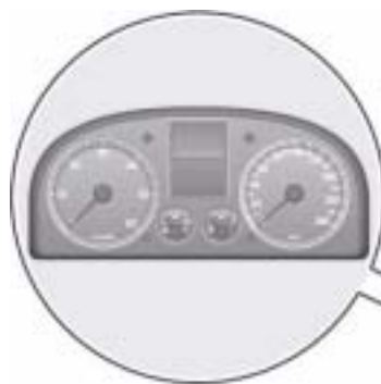
Steuergerät mit Anzeigeeinheit im Schalttafeleinsatz J285
