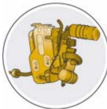
Steuergerät für Heizung J162 vorne rechts unter dem Kotflügel
