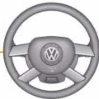
Bedieneinheit am Lenkrad E221 Slave-Steuergerät im LIN-Datenbus
