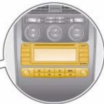
Steuergerät mit Anzeigeeinheit für Radio und Navigation J503 oder Radio R in der Mittelkonsole
